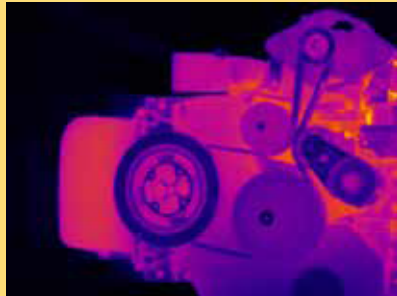
對發動機的散熱系統、排氣系統、傳動系統進行熱分佈檢測，改善設計佈局
